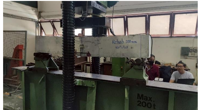
รูปที่ 23 การโก่งตัวของคานาติดตั้ง Rehab Bar 200 mm หลังทดสอบ
